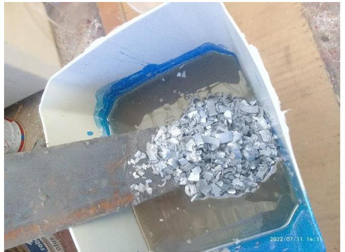
Nos ponemos la mascarilla y echamos en el cubo la resina, después, empezamos a echar virutas hasta que tiene una mediana saturación. Sin saturar la mezcla de virutas aún, echamos el catalizador
