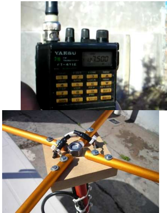
Detalle de la construcción de nuestra antena (centro de dipolos)
